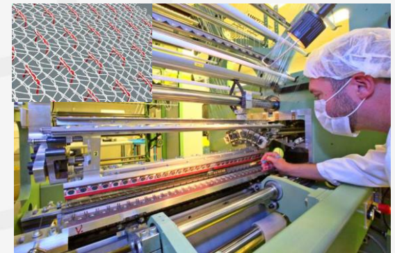
Orvosi eszközök (pl. hasfali hálót) gyártó lánchurkológép
