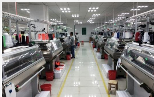
Elektronikus mintázású, automata síkkötőgépek
